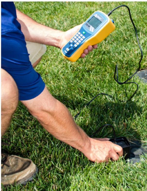
Werkseitig konfigurierte Decoder-In-Head (DIH)-Rotoren sind für alle Ventil-in-Kopf-TTS-Rotoren der Serien 800 und 900 erhältlich. Alle DIH-Rotoren sind mit der Total Top Programming-Technologie von Hunter ausgestattet. Ob auf der Werkbank oder nach dem Einbau, die Decoderstation lässt sich ohne Rotordemontage programmieren.
