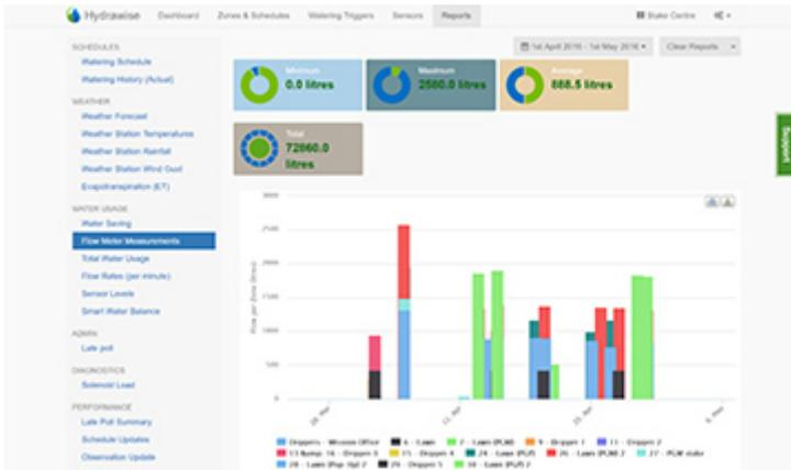
Überwachen Sie den Zustand des Leitungssystems über einen optionalen Durchflussmesser. So erhalten Sie automatische Warnmeldungen bei einem defektem Rohr und können Geländeschäden vorbeugen.
