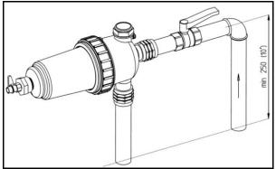
Fig. 2: 90<sup>0</sup> Angle installation
